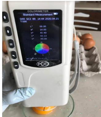
Resim 3. Kolorimetre ile renk ölçümü
